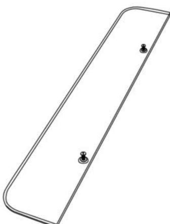
Положите полку на пол. Сначала вставьте два болта M6, чтобы они попадали в отверстия двух шайб M8.
