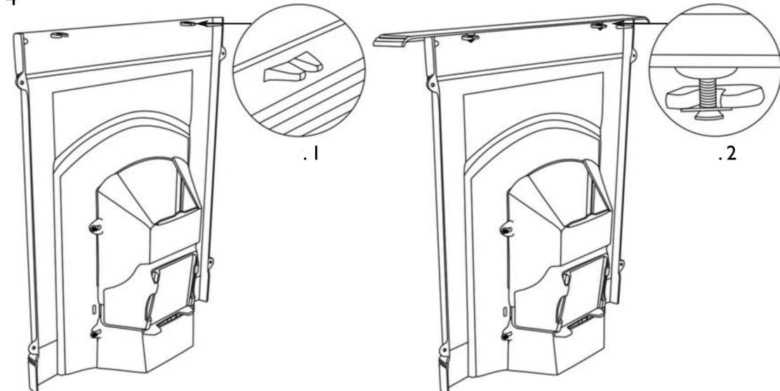
Положите каминную полку на камин и вставьте два винта M8 в отверстия на полке таким образом, чтобы они проходили через крепежные выступы (рис.1). Шайбы должны быть под крепежными выступами (рис.2). Затяните с помощью плоской отвертки.
