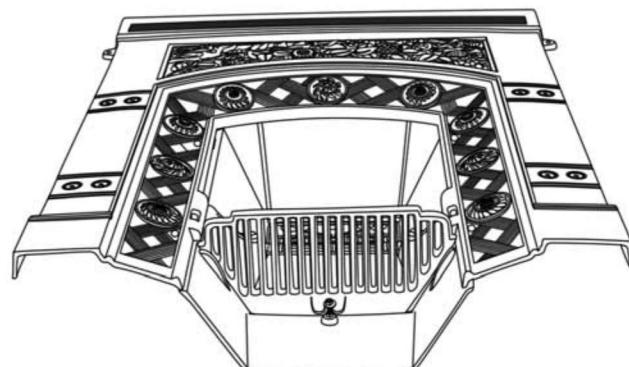
Вставьте колосник в пазы над гайкой M6. Закрепите на месте при помощи шайбы и болта M6.
